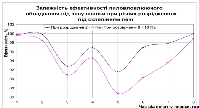
Рисунок 1. Залежність ефективності пиловловлювання від часу плавки при різних розрідженнях під склепінням печі
