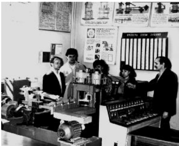
Майбутні інженери-механіки вивчають металургійне обладнання на діючій моделі прокатного стану
