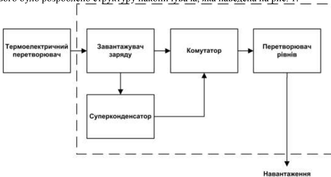
Рисунок 1 – Структура накопичувача електричної енергії
